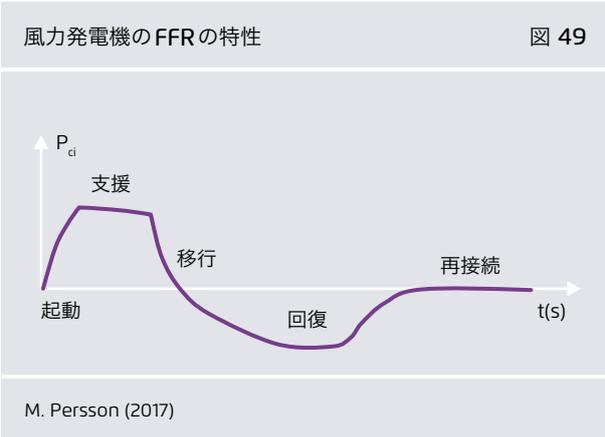
→ **移行の段階**。電力が風力発電機の運動エネルギーから引き出されるため、発電機が速度が低下する。速度が一定限度以下になると、発電機が停止し電力が完全に失われる場合がある。そのため、発電機を定格速度に戻す必要がある。そこで、この段階では制御装置が適切なタイミングを決めて支援の段階から回復の段階へと移行する。
