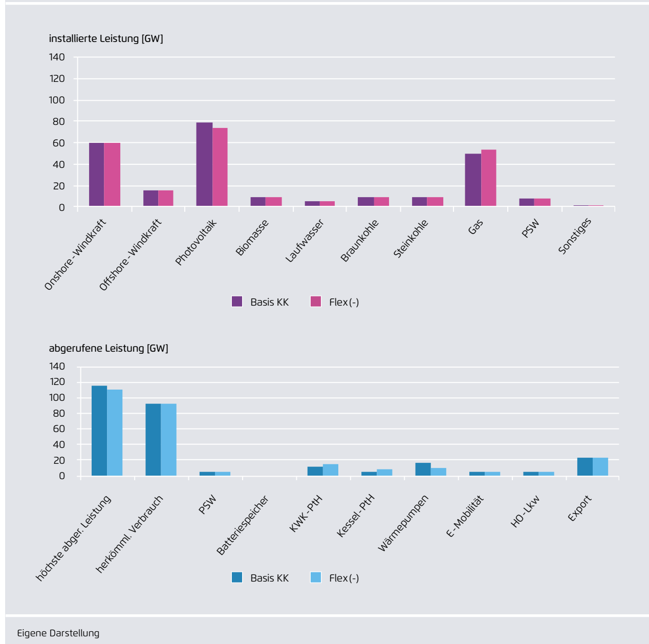
Installierte Erzeugungsleistungen (oben) und maximal abgerufene Verbrauchsleistungen (unten) für die Defizitvariante mit weniger dezentraler Flexibilität im Vergleich zum Basisszenario
