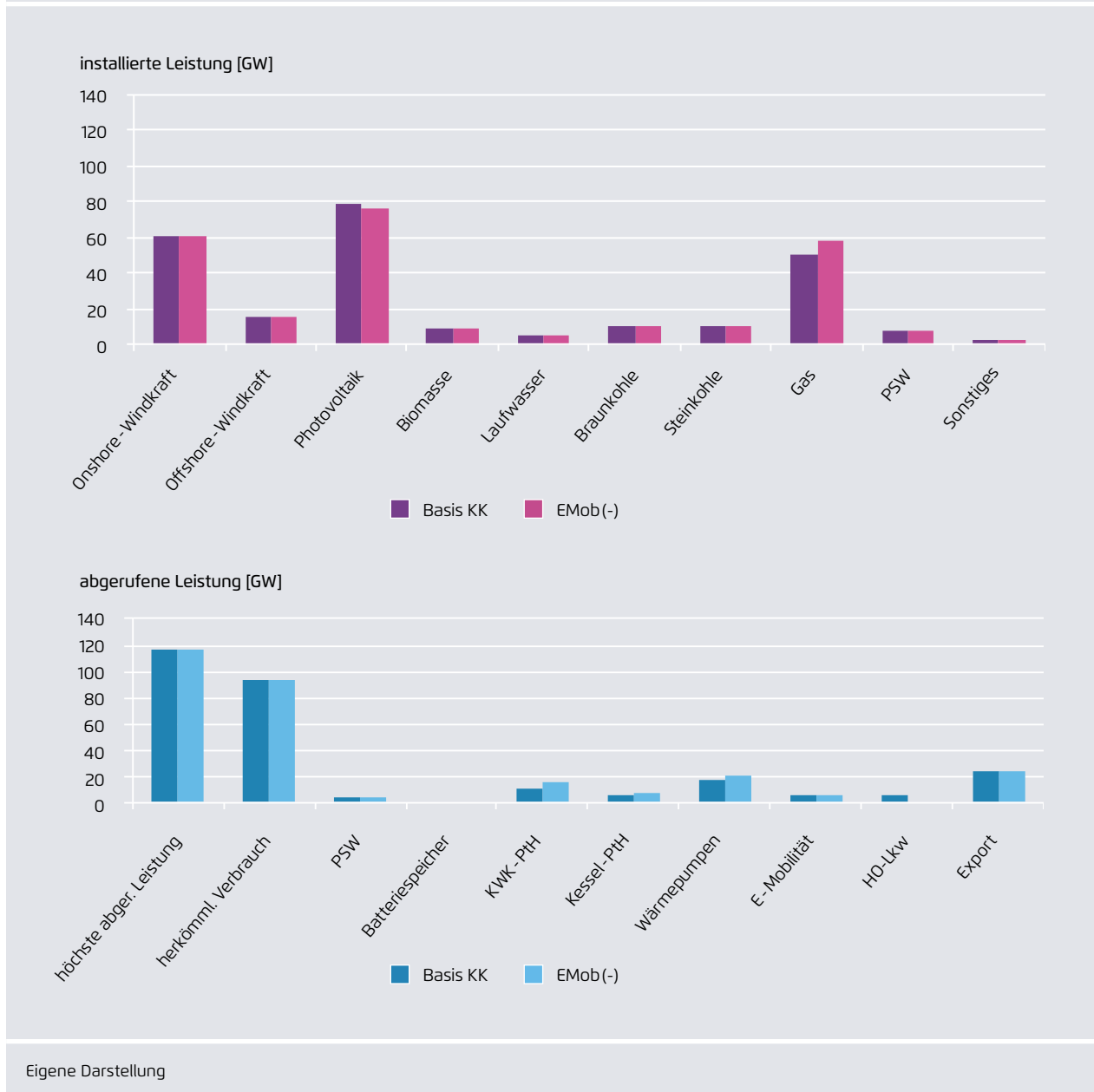
Installierte Erzeugungsleistungen (oben) und maximal abgerufene Verbrauchsleistungen (unten) für die Defizitvariante mit weniger E-Mobilität im Vergleich zum Basisszenario
