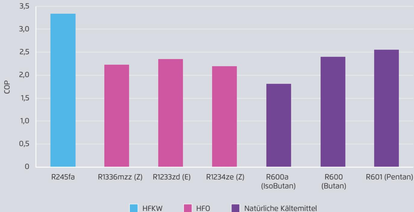
Fraunhofer IEG basierend auf Mateu-Royo et al. (2021). \* Temperaturhub (60 K), Senktemperatur (130 °C) und Kreislaufkonfiguration werden bei allen Kältemitteln konstant gehalten
