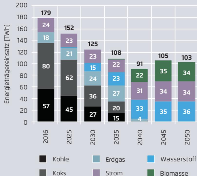
\* In der Abbildung ist der Energiebedarf nicht als Endenergiebedarf im Sinne der Energiebilanz angegeben, sondern als Energieeinsatz ab Werktor (unter Ausschluss der Kokereien). Eine Gutschrift für die Erzeugung von Strom aus Kuppelgasen erfolgt hier nicht.
