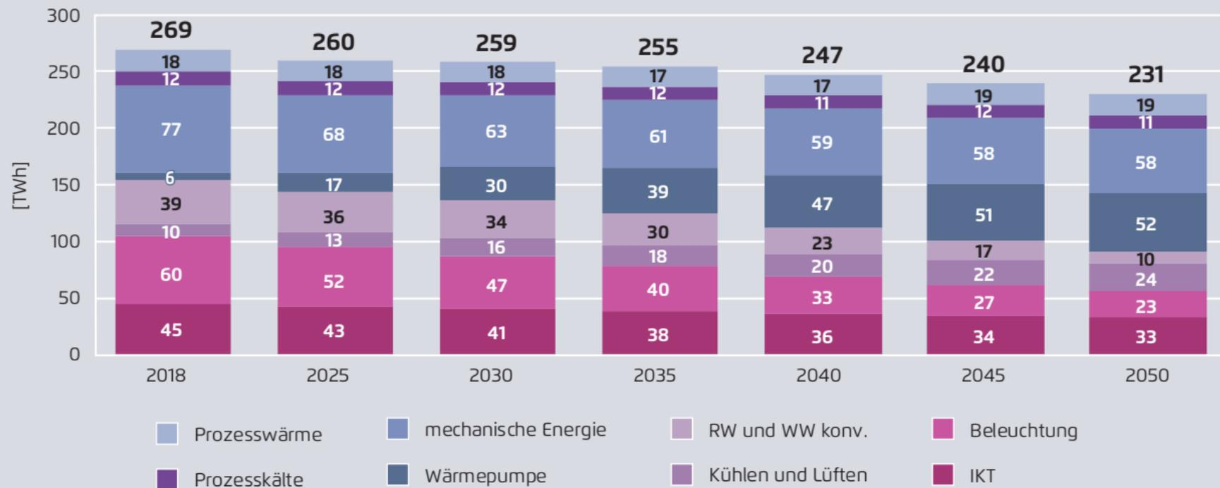
Hinweis: „Wärmepumpe“ beinhaltet den Stromverbrauch für den Betrieb der Wärmepumpe, „RW und WW konventionell“ beinhaltet den Stromverbrauch von konventionellen Stromdirektheizungen. „Mechanische Energie“ umfasst den Stromverbrauch gewerblicher Prozesse, aber auch den Stromverbrauch von Haushaltsgeräten, also Kühlschränken, Waschmaschinen, Geschirrspülern, Staubsaugern etc. Prognos (2020)
