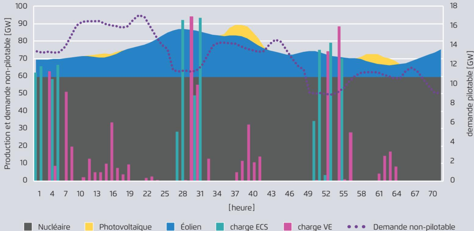
Résultats issus du modèle Artelys Crystal Super Grid. La figure indique la production nucléaire, éolienne, PV, consommation non pilotable (axe de gauche) et la demande pilotable (axe de droite).
