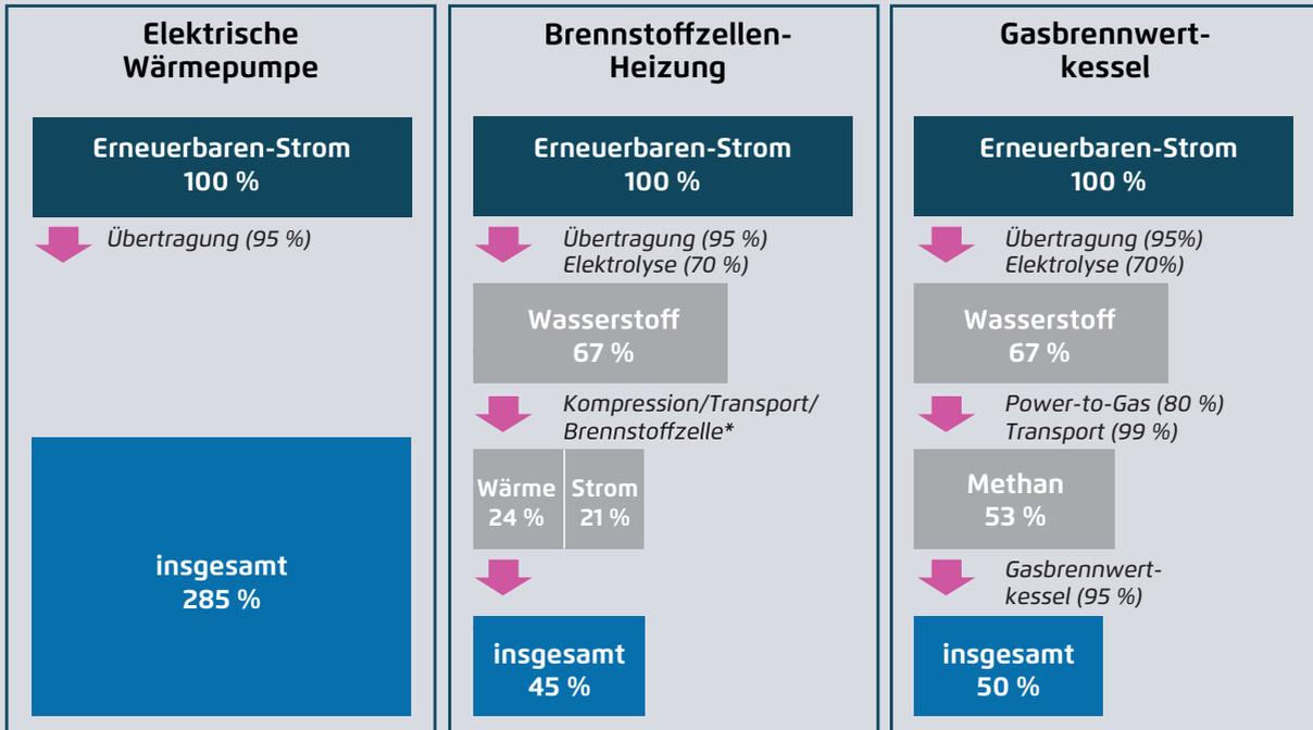
\* Wirkungsgrade: 80 Prozent (Kompression/Transport) und 85 Prozent (Brennstoffzelle insgesamt, davon 45 Prozent Wärme, 40 Prozent Strom)
