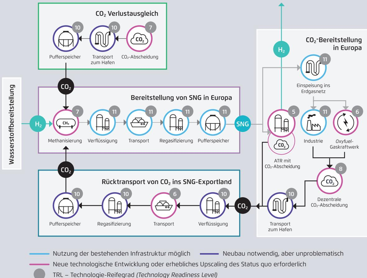
CO<sub>2</sub> = Kohlenstoffdioxid, H<sub>2</sub> = Wasserstoff, O<sub>2</sub> = Sauerstoff, SNG = synthetisches Erdgas, ATR = autotherme Reformierung, TRL = Technologie-Reifegrad
