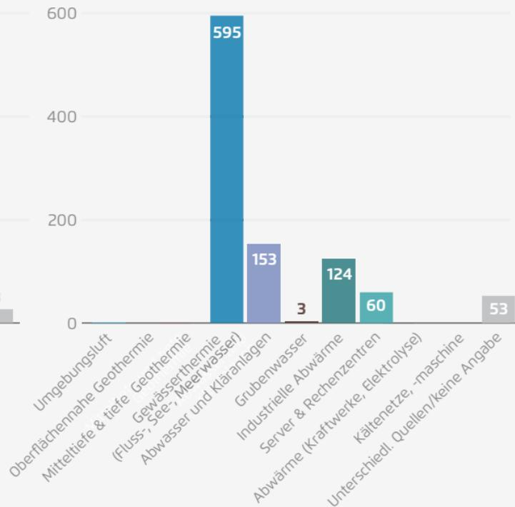
Fraunhofer IEG (2023) basierend auf Marktrecherche • Über 70 Prozent der hier erfassten 100 Großwärmepumpen sind in Wärmenetzen installiert. Die tatsächliche Großwärmepumpenanzahl und -leistung liegt etwas höher, da bspw. zu einigen (geplanten) Projekten keine Heizleistung bekannt ist und Daten zu Großwärmepumpen in der Industrie nur begrenzt öffentlich verfügbar sind.
